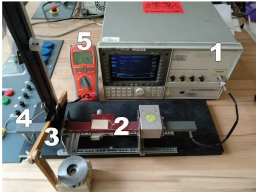
Rys. 21. Stanowisko pomiarowe, 1 – generator, 2 – falowód, 3 – szczelina pomiarowa (na próbkę), 4 – detektor, 5 – woltomierz.
