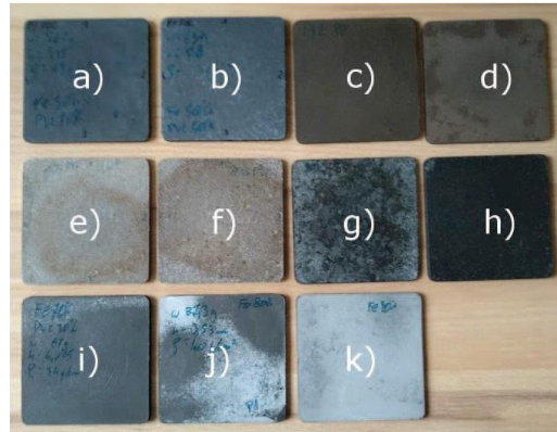
Rys. 22. Próbkę kompozytów: a) 30% Fe; b) 50% Fe; c) 80% pył stalowy; d) 90% pył stalowy; e) 80% ruda Zn; f) 90% ruda Zn; g) 80% zendra; h) 90% zendra; i) 70% proszek Fe; j) 80% proszek Fe; k) 90% proszek Fe
