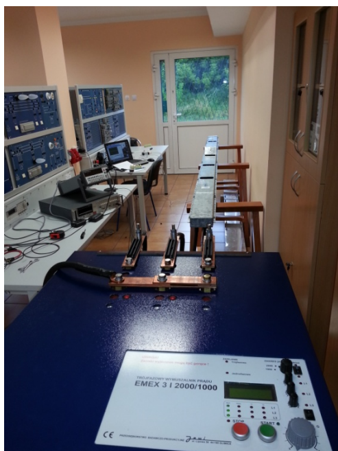
Rys. 5. Szynoprzewód typu MR wyprodukowany przez firmę Elektromontaż nr 2 w Katowicach: a) stanowisko badawcze, b) układ pomiarowy do pomiaru pola magnetycznego
